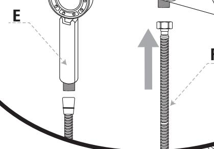
Assurez-vous que les rondelles de caoutchouc sont en place. Alignez soigneusement le filetage et, à la main, serrez fermement. **N'utilisez pas de clé à molette ou de pinces.**
