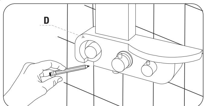
Vous pouvez maintenant marquer l'emplacement des trous du module tablette (D). Utilisez la mèche appropriée pour percer votre mur. Insérez les ancrages (K).
