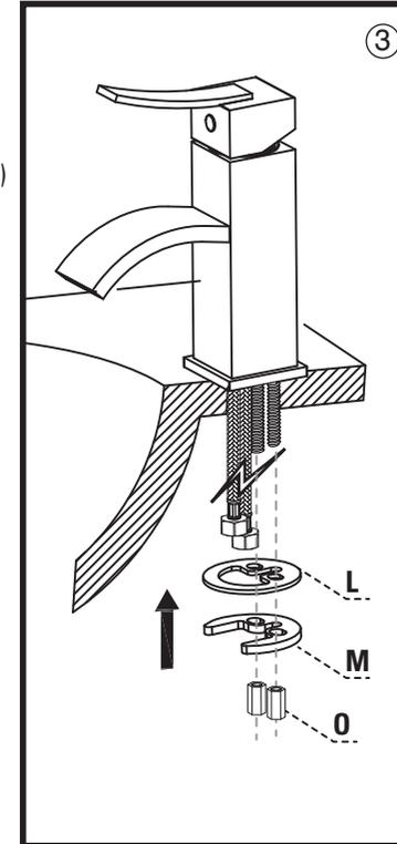
3. Une fois le robinet en place sur le lavabo, tel qu'illustré, placez d'abord la rondelle de caoutchouc (L), puis placez la rondelle de métal en U (M) et terminez avec les écrous hexagonaux (O).
