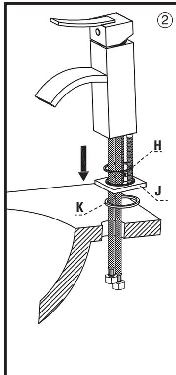
2. Tel qu'illustré, placez d'abord la rondelle de caoutchouc (H), puis la bride du robinet (J) et terminez avec la rondelle de caoutchouc (K). Insérez ces éléments par le trou du lavabo.
