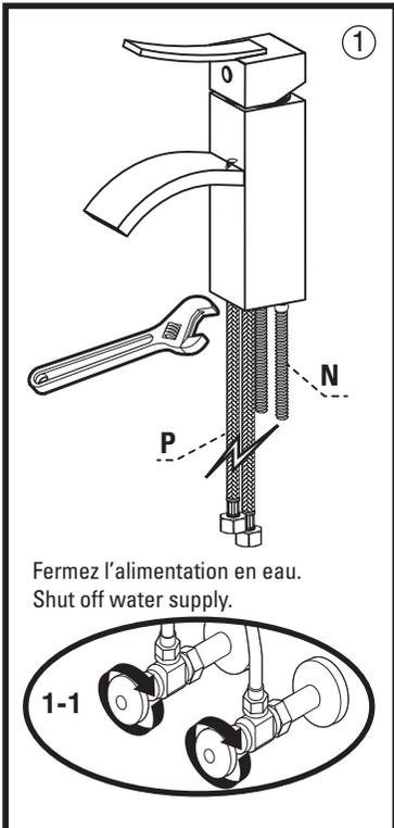
1. Fixez les deux boyaux d'alimentation en acier inoxydable tressé (P) en serrant manuellement, puis en serrant 1/8 de tour supplémentaire à l'aide d'une clé à molette. Fixez ensuite les deux goujons filetés (N) en serrant fermement manuellement.
