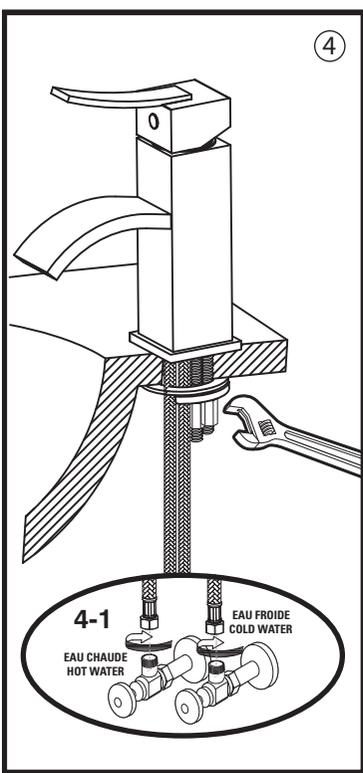
**4.** Serrez les écrous hexagonaux fermement en place. Raccordez maintenant les boyaux d'alimentation en acier inoxydable tressé à vos valves d'alimentation (non incluses). Voir figure 4-1. Serrez manuellement et serrez d'un quart de tour supplémentaire à l'aide d'une clé appropriée. Assurez-vous de ne pas endommager les raccords tressés.
