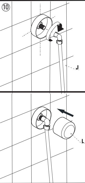
**10.** Raccordez le boyau d'alimentation au joint de prolongation en laiton. Ne serrez pas trop. Installez le couvercle du raccord de la pomme de douche.
