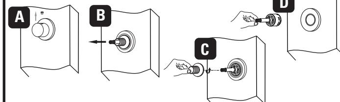
Effectuez le processus inverse pour mettre la cartouche en place. Reverse this process when putting the cartridge in place.
