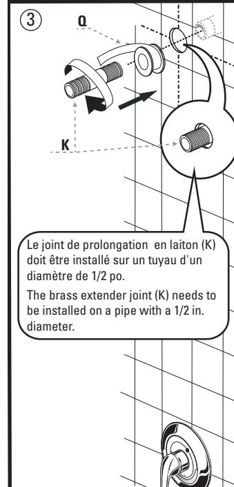
Le joint de prolongation en laiton (K) doit être installé sur un tuyau d'un diamètre de 1/2 po.
