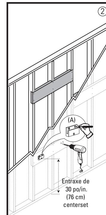
**2.** Installez les 2 supports muraux du meuble(A) avec un entraxe de 76 cm à partir du sol. Il est préférable de mesurer, de positionner, de marquer et de prépercer le mur à l'endroit où seront fixés les supports. Les supports réglables(B) du meuble pour l'installation murale ont été installés en usine.
