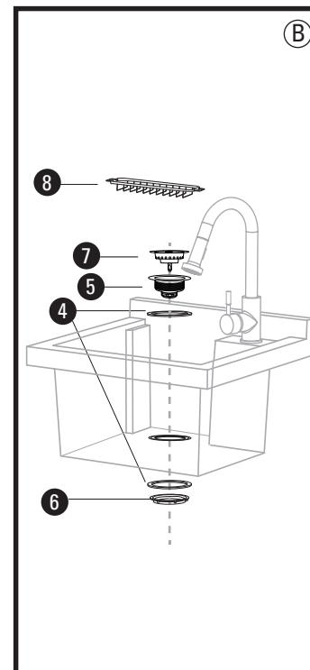
Installez une rondelle de caoutchouc (4) sur le drain au fond de la cuve et insérez la crêpine (5). Placez une seconde rondelle de caoutchouc sous la cuve, autour de la crêpine. Alignez soigneusement le contre-écrou (6) avec la crêpine et serrez légèrement le contre-écrou à l'aide d'une pince. Mettez le couvercle (7) et le porte-savon en place (8).
