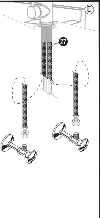
Raccorder les boyaux d'alimentation en acier inoxydable tressé (27) aux robinets d'alimentation tel qu'illustré (figure E). Raccordez le boyau serti de rouge au tuyau d'alimentation en eau chaude et raccordez le boyau serti de bleu au tuyau d'alimentation en eau froide.
