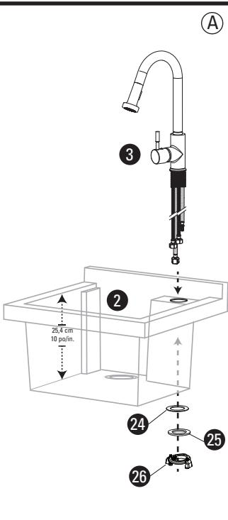
Placez le robinet sur la cuve. Placez la rondelle en caoutchouc (24) ensuite la rondelle en métal (25) sur les tuyaux du robinet tel qu'illustré (figure A). Alignez soigneusement le filetage du contre-écrou (26) avec le robinet. Serrez le contre-écrou à la main et serrer fermement les vis.
