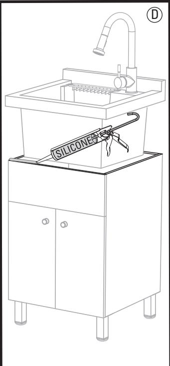
Il est essentiel d'appliquer un joint de silicone autour de l'armoire afin d'en assurer la stabilité et l'étanchéité. Vous préviendrez ainsi les dommages liés aux infiltrations d'eau.
